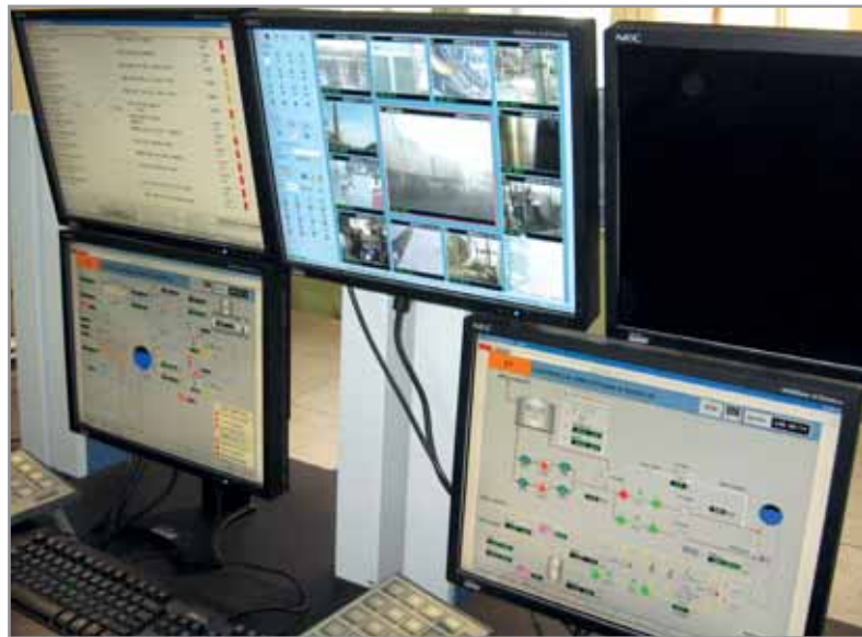
Le 'networkcamere' Pan Tilt Zoom si integrano nella rete Ethernet e si interfacciano con gli apparati presenti in loco
