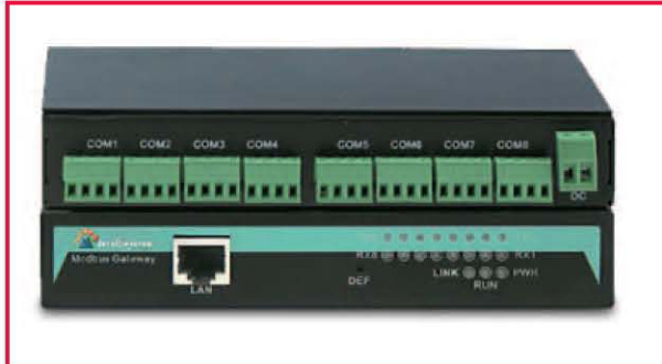
Fig. 8 – I gateway per reti industriali Intellisystem IT-ENG-110x interfacciano i protocolli Modbus-TCP, Modbus-RTU e le connessioni Ethernet, RS-485/422 e RS-232
