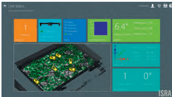
Una vista del sistema di gestione di Shapescan3D di Isra Vision destinato al bin picking ad alta velocità
