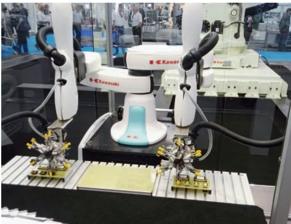
Nel campo della robotica collaborativa Kawasaki propone non un singolo braccio, ma un doppio braccio robotizzato, denominato Duaro
