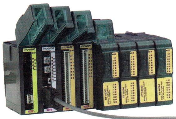
esempio 8 assi con 8 DAC, 8 encoder incrementali, 16 ingressi digitali e 16 uscite digitali vengono gestiti in meno di 100 ms, un tempo irraggiungibile dai classici fieldbus. Interessante caratteristica di tutta la gamma è il range operativo di temperatura, da 0 a 70 °C.
