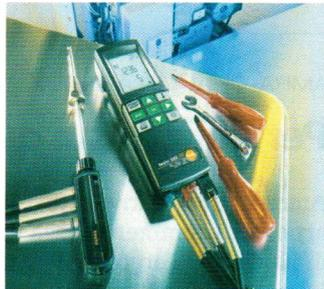
325 M è un analizzatore di gas combustibili
