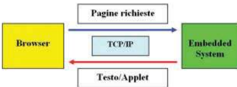
Figura 2 Esecuzione di Applet Java per eseguire operazioni di controllo o di monitoraggio di dispositivi remoti
