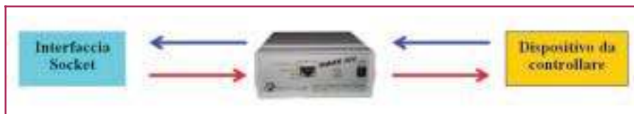
Figura 2: Schema funzionale per la gestione di un dispositivo elettronico tramite RECS 101
