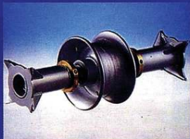
M9 - Rullo per entrata cavo pozzetti, con cuscinetti a sfera e due martinetti a cannocchiale per posizionamento orizzontale.
