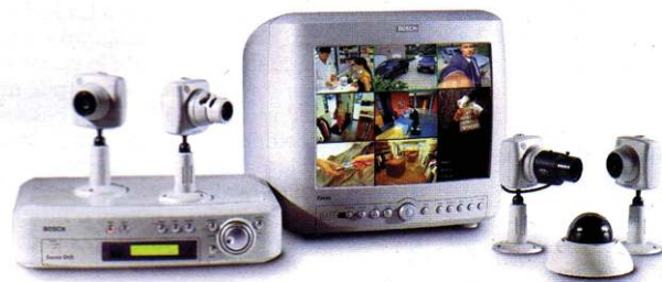
Il sistema Eazeo, a colori o in bianco e nero, viene fornito in una soluzione "All-in-one" con un kit completo comprensivo di monitor, telecamera, cavi e connettori, soddisfacendo i requisiti di base di un sistema di videosorveglianza. Ulteriori telecamere, monitor slave, videoregistratore e accessori consentono di espandere con semplicità il sistema
