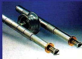
M10 - Rullo a cuscinetti radiali. Martinetti a cannocchiale. Per percorsi ad angolo su pozzetti.
