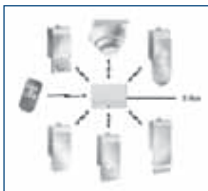
SiRoute è un sistema che offre una infrastruttura con tecnologia radio bidirezionale per i sistemi di allarme
