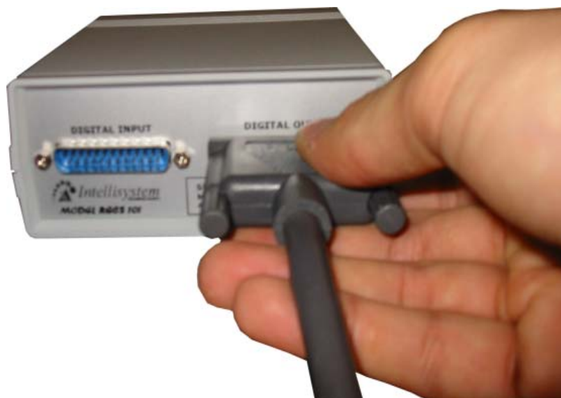
Fig. 9 - Connessione di RECS 101 al dispositivo da controllare.
