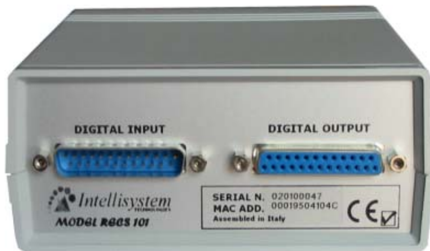
Fig. 5 - Porte di I/O.
