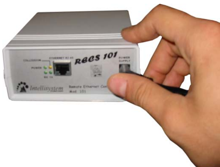
Fig. 7 Connessione dell'alimentatore a RECS 101.
